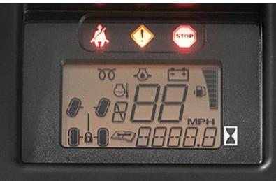
**Ve más con un solo vistazo:** El tablero de instrumentos digital actualizado muestra más información de forma más clara y fácil de usar. Los más destacables son un indicador de selección de la marcha actual, un lector de r. p. m. y señales de advertencia de velocidad, nivel de combustible y estado de bloqueo de TDM/Dif.
