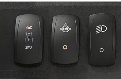
**Más control y confort:** El sistema mecánico actualizado de transmisión a las 4 ruedas (TDM) se activa electrónicamente e incorpora Active Hill Descent (Descenso activo de colinas) para un funcionamiento más intuitivo y seguro. Para activar el bloqueo de TDM o Dif., simplemente acciona el interruptor electrónico en el salpicadero ¡y disfruta de la rápida respuesta!
