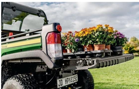
**Puerta trasera Deluxe de la caja de transporte y almacenamiento:** La puerta trasera ha sido mejorada para una carga y descarga más sencilla, incluye características funcionales de un camión y puede manejarse con una sola mano. Puede abrirse o extraerse para facilitar la limpieza o para acomodar artículos de gran longitud. Las correas instaladas de serie pueden desmontarse para bajar la puerta trasera 150°.
