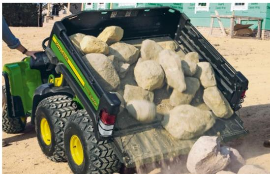
**Inclinación de la caja Deluxe de carga y almacenamiento:** Con un diseño de asa integrada y asistencia de gas, la caja de transporte y almacenamiento Deluxe ahora es más fácil de cerrar, abrir, subir y bajar. Se proporciona una barra de apoyo para mantener la caja en la posición vertical y limitar el recorrido de su pivote.
